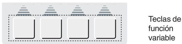
En función de la situación de medición cambian los símbolos debajo de las teclas de función variable. Al pulsar las teclas se activan funciones o se accede a un nivel secundario.
